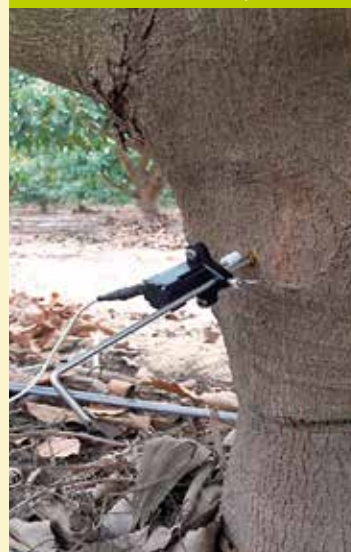
Dendrmetro instalado en tronco de rbol de palto
