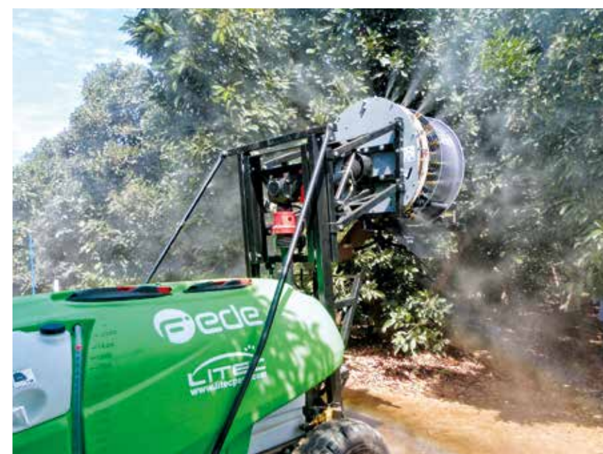
descripción: se puede observar la correcta cobertura hasta 9 m de altura.
