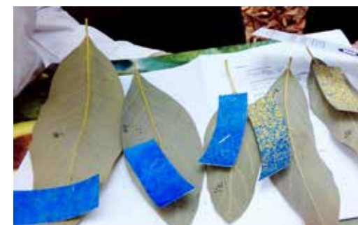
descripción: se puede observar la correcta cobertura hasta 9 m de altura.
